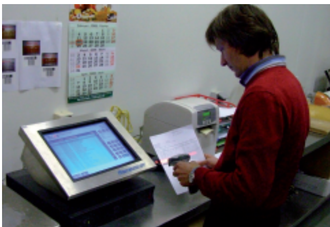
Producten met een EAN13 code, dienen aan de Flex CT Terminal te worden gescand, die aan een weegschaal is gekoppeld. Vervolgens moeten ze op de weegschaal worden gelegd, waarna het gewicht op orderregel wordt geregistreerd.
